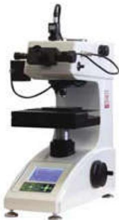
Figura 11. Aparato para microdureza Vickers modelo 402-MVD de Foundrax-Wolpert
