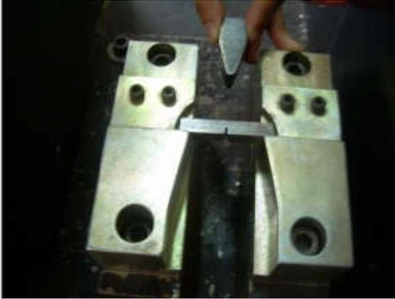
Soporte para Probetas de un ensayo de impacto Charpy
